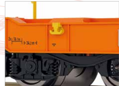
■ Seilankerhaken farblich abgesetzt
